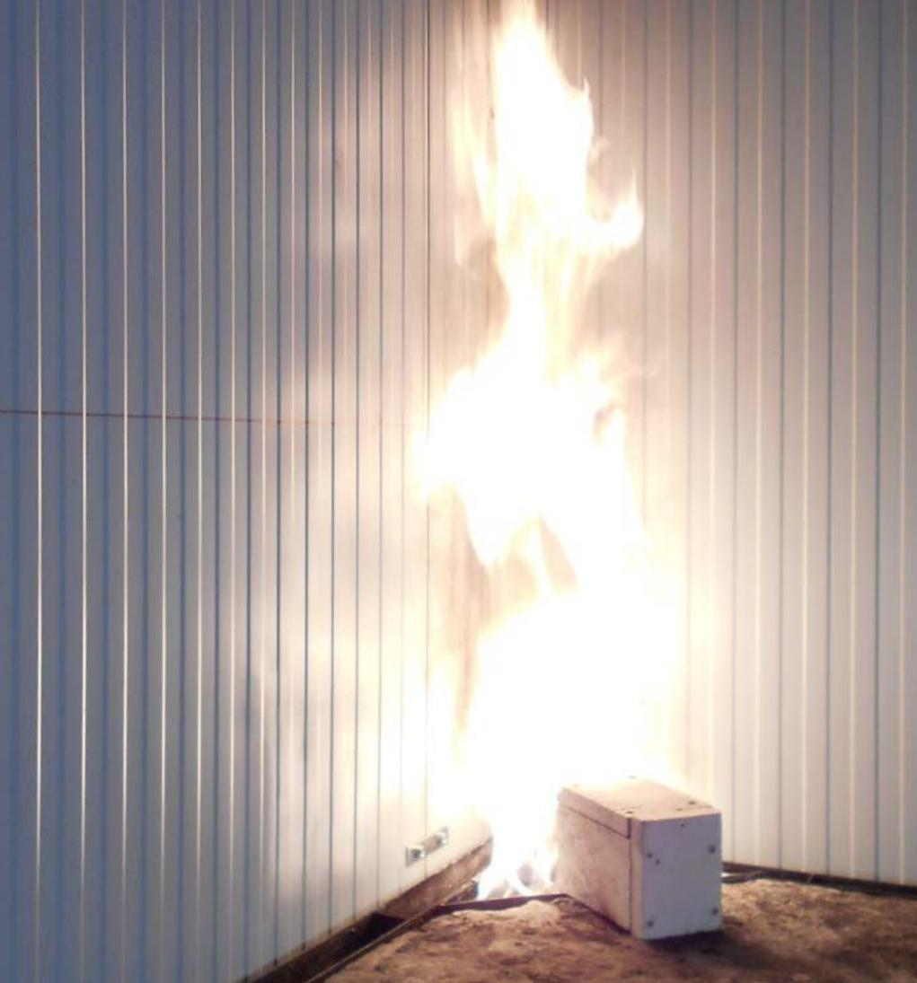
Test d'élément isolé en combustion (SBI)
